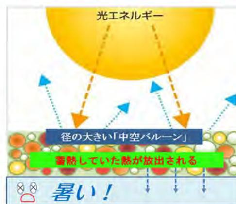
一方、チルコートHSPは微小な天然セラミックパウダーを使用しているため、極限まで高めた反射効率の良さで 塗装面を発熱させず、また塗膜に蓄熱しない上に天然セラミック自体の熱伝導率の低さで断熱性能にも優れています。つまり、熱を発生させず、また蓄熱もしないので長期間にわたって適温を保持することができるのです。
